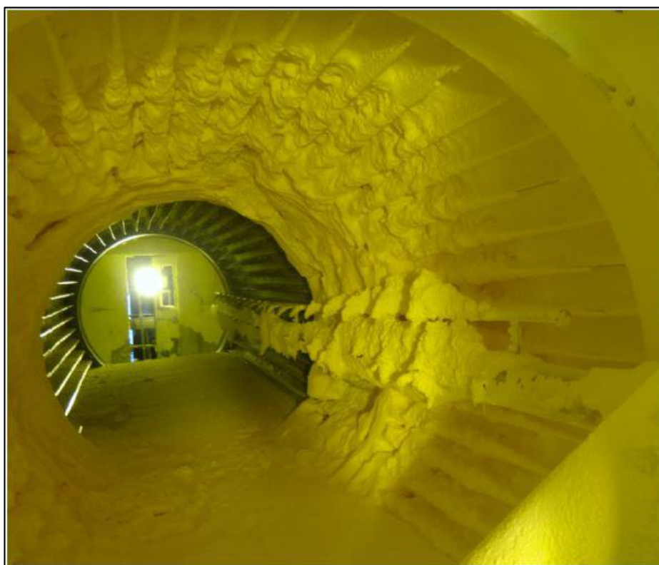
Фото 5 Состояние барабана грануляции при сбоях технологического режима
