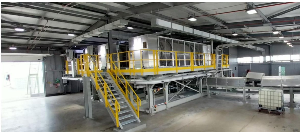
Фото 2 Мобильная установка грануляции серы GX
