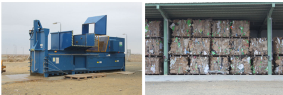
Фото 31 Пакетировочный пресс WHS 650 HDE и спрессованный картон после пресса в виде брикетов на ТЭЦ
