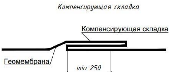
Рисунок 3 – Схема компенсирующей складки.
