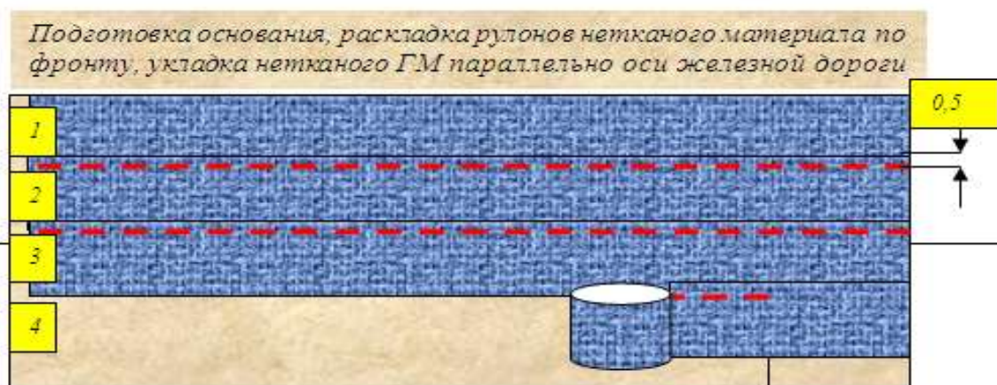
Рисунок 3.5.2 - Укладка нетканого геотекстиля
