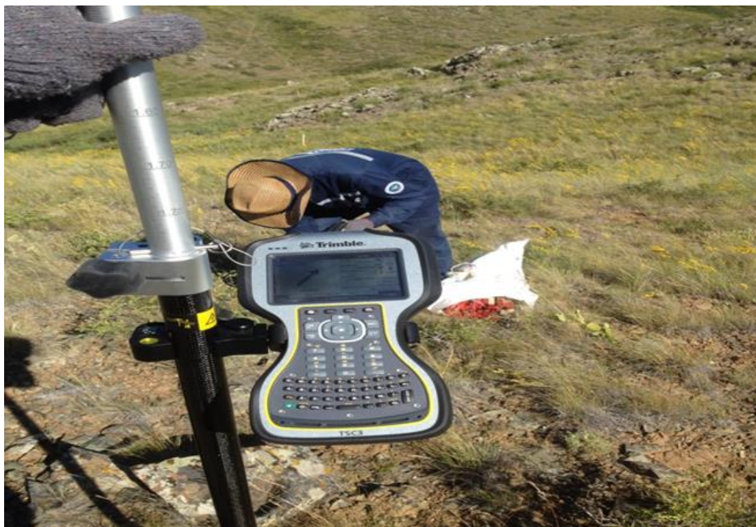
Рис 4.3. Разбивка профильных листов в режиме RTK
