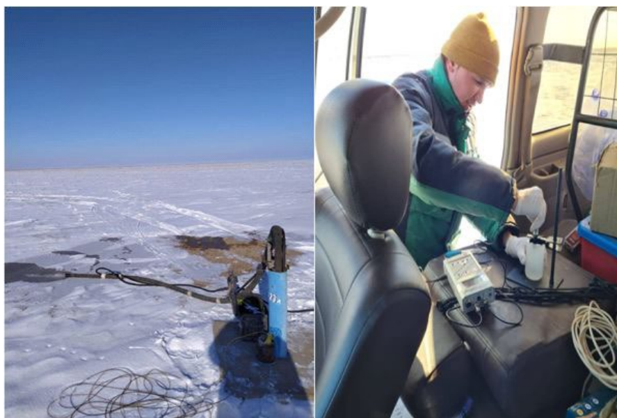
Рис. 4.8.17 - Прокачка скважины слева, и замер полевых значений в пробе справа
