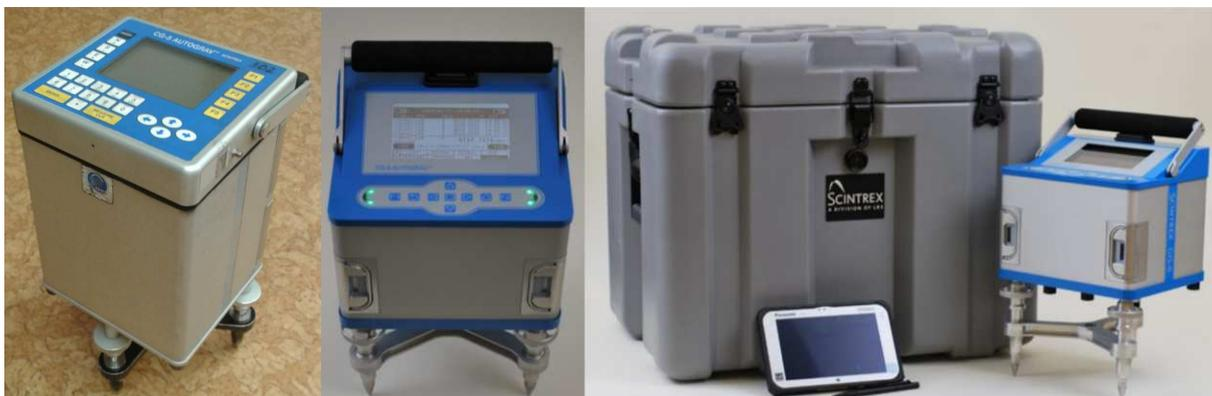
Рис. 3.4.3.3. Внешний вид гравиметров Autograv CG-5 и CG-6
