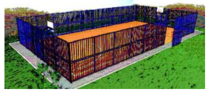
Ограждение в 2 яруса из стальных панелей из металлических прутьев высотой 2,0 м по металлическим столбам высотой 4,0 м
