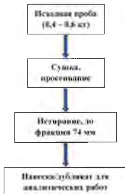
Рисунок 5.5.2. - Схема обработки литохимических проб (ТЛГХ)
