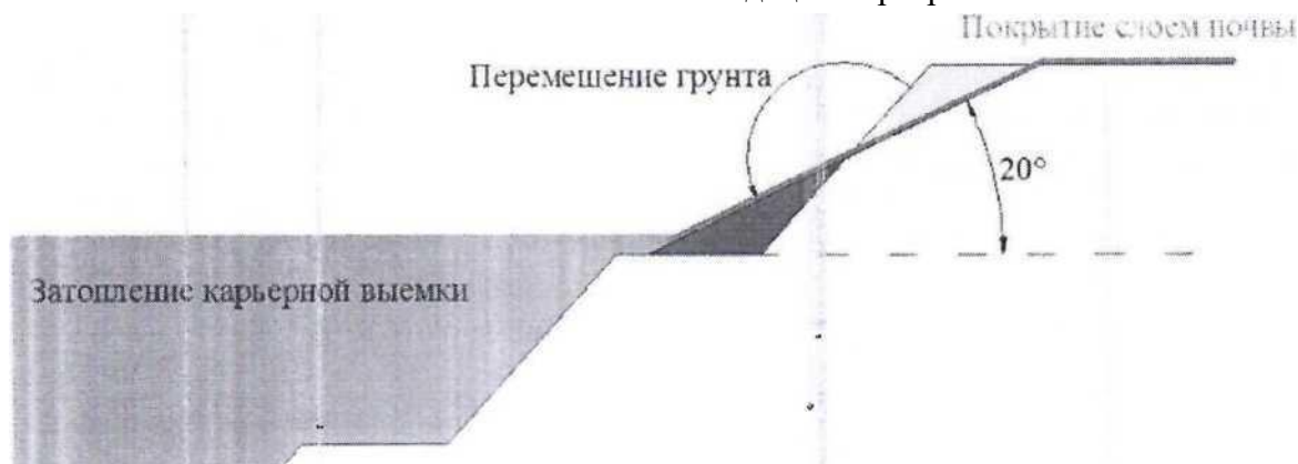
Рис. 5.4 - Схема ликвидации карьеров
