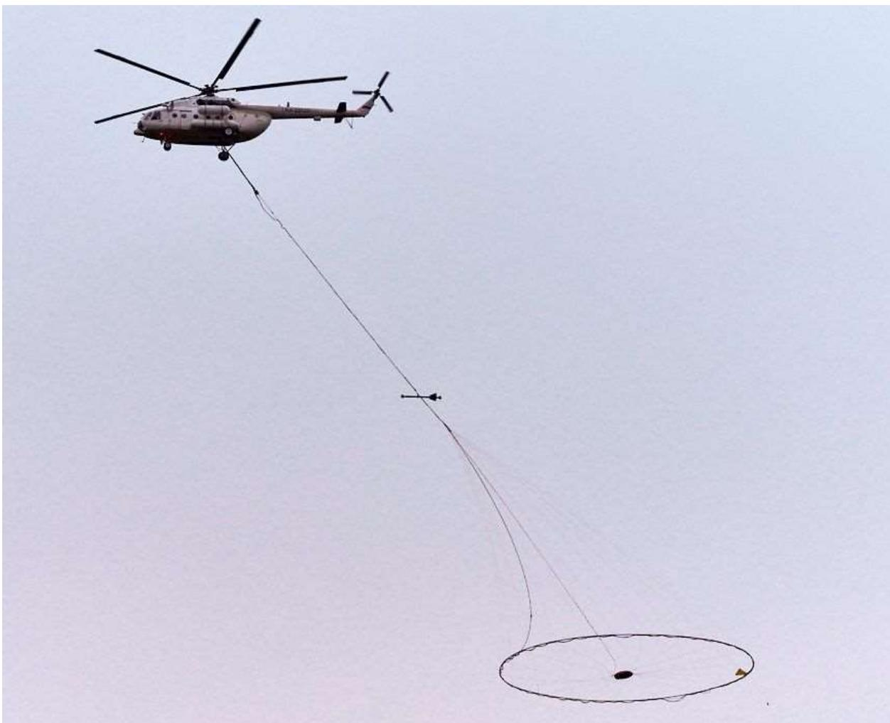
Рис. 4.7 Выполнение аэро-электроразведки
