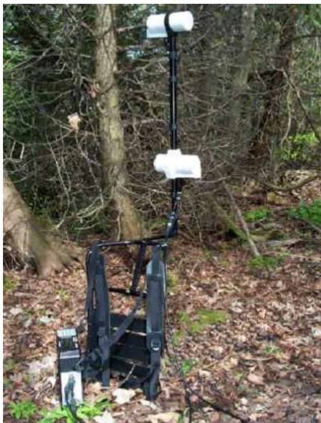
Рис. 4.3 Магнитометр GSM-19 в рабочем положении
