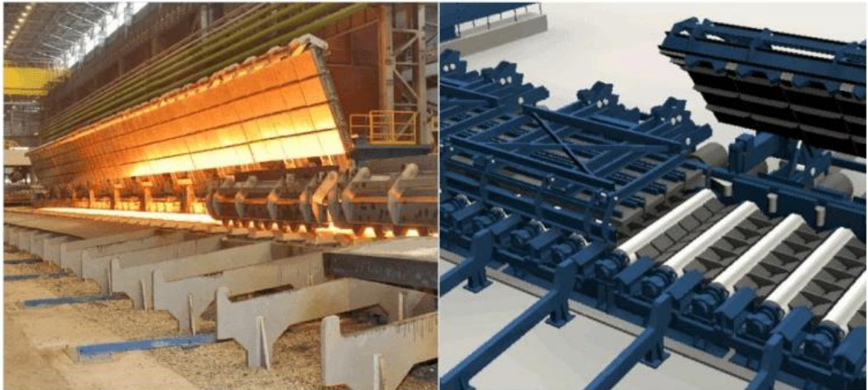
Рисунок 5.8 - Тепловой экран типа «энкопанель»
