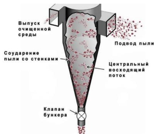
Рисунок 5.11 - Базовая схема устройства циклона
