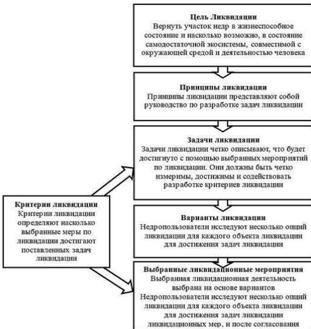
Рис.5.1 Схема планирования ликвидации
