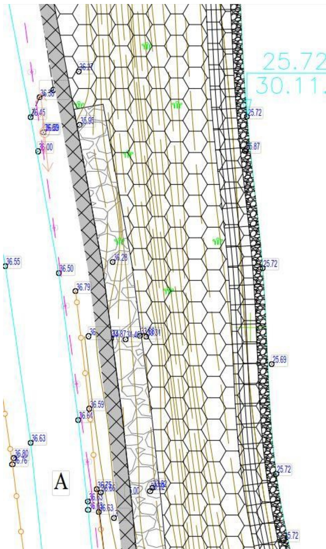
Схема расположения габионов и расширения берега
