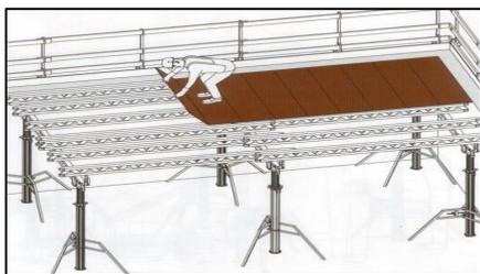
Рис. 22. Укладка листов фанеры: 1 - поперечная балка; 2 - укладываемый щит; 3 - уложенный и закрепленный щит; 4 - ограждение по периметру перекрытия
