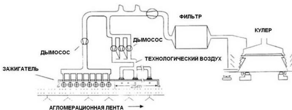
Рисунок 5.4.2.1 Рекуперация тепла воздуха, используемого при охлаждении агломерата
