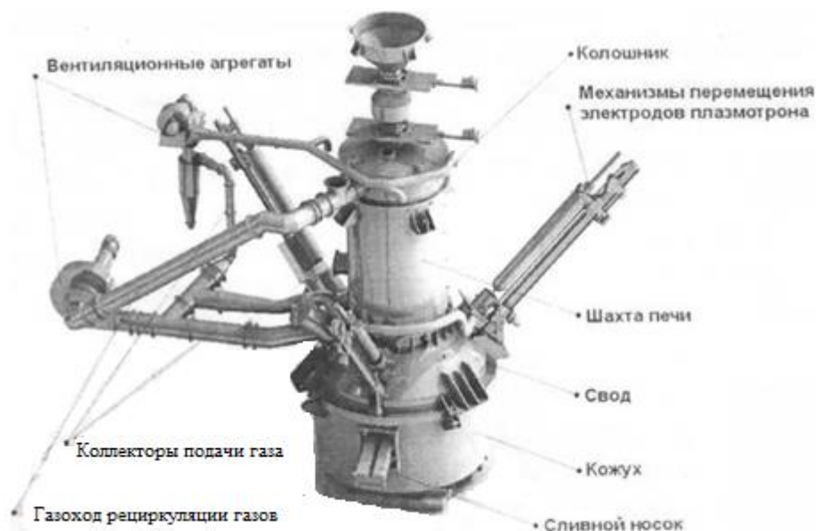
Рисунок 7.9.1 Общий вид плазменной шахтной печи для технологии "EPOS-process"
