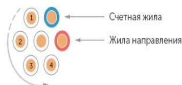
Красным цветом обозначается направляющая жила, она предназначена для определения направления, в котором должен быть произведен отсчет для нахождения искомой жилы.
