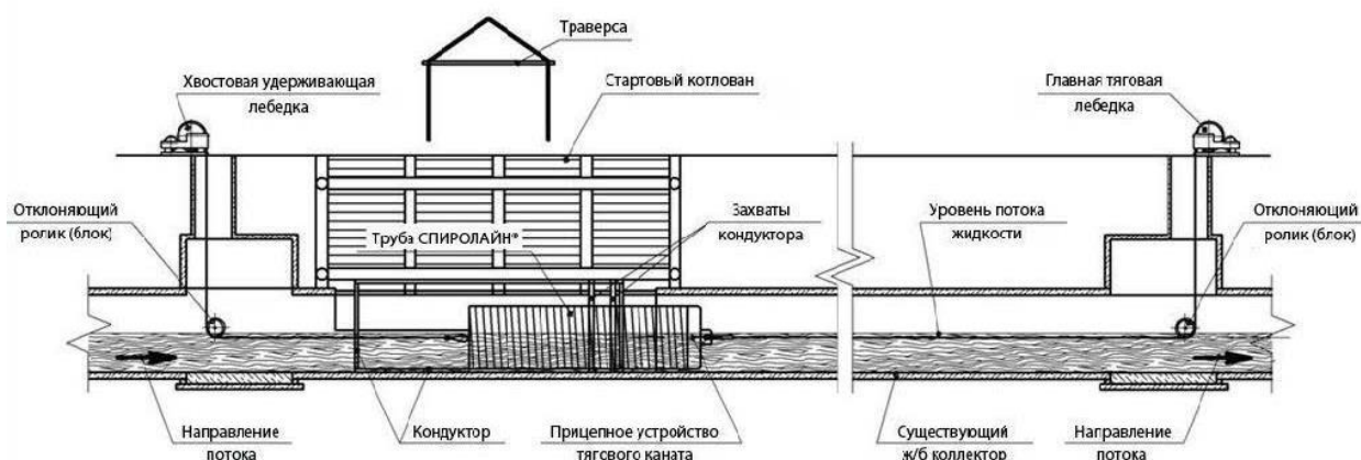
Схема производство работ методом "Санации"
