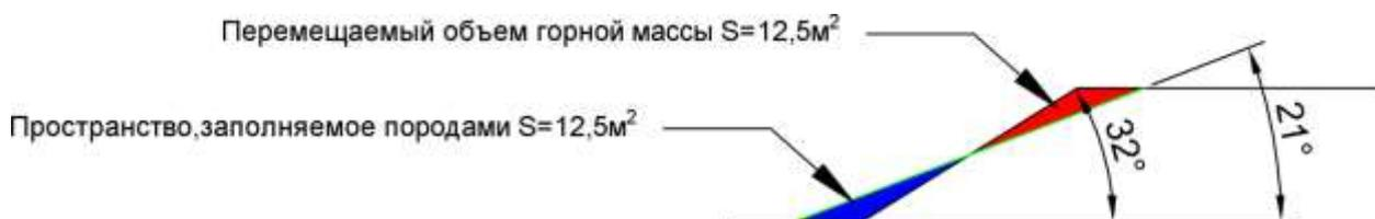
Рис.5.2.1. Схема выколаживания яруса отвала
