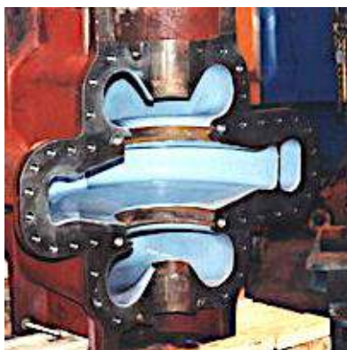
Рис.5.62 – Вид обработанного гидрофобным покрытием корпуса насоса
