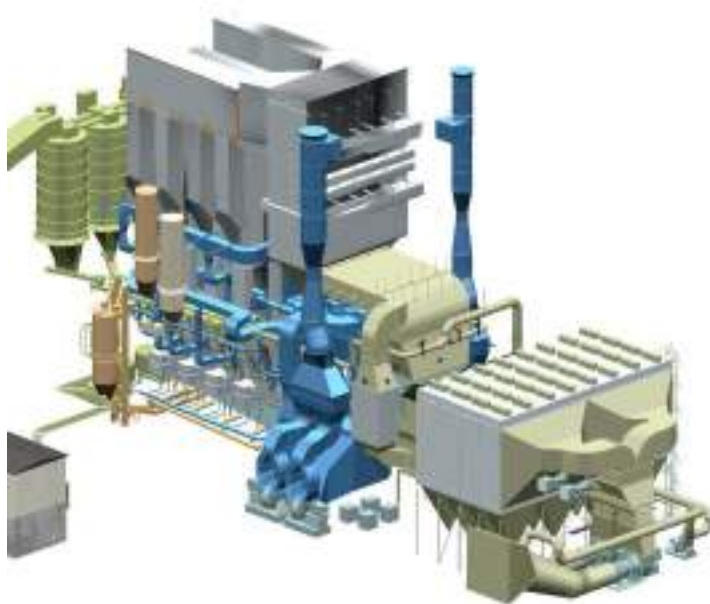
Рис. 5.9 - Энергоблок с ЦКС мощностью 460 МВ
