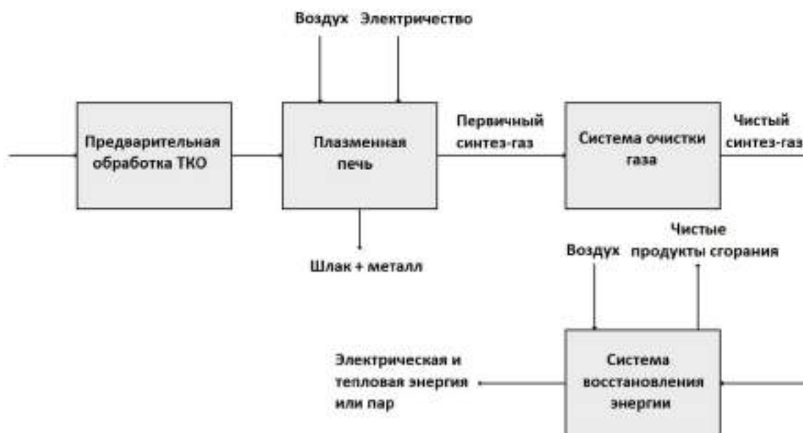
Рис. 5.52 - Блок-схема газификации ТКО с использованием плазменных источников энергии
