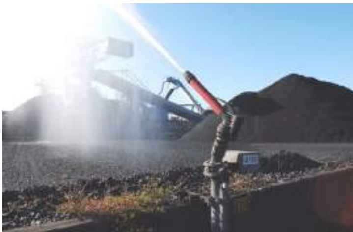
Рис.3.19 - Увлажнение склада угля
