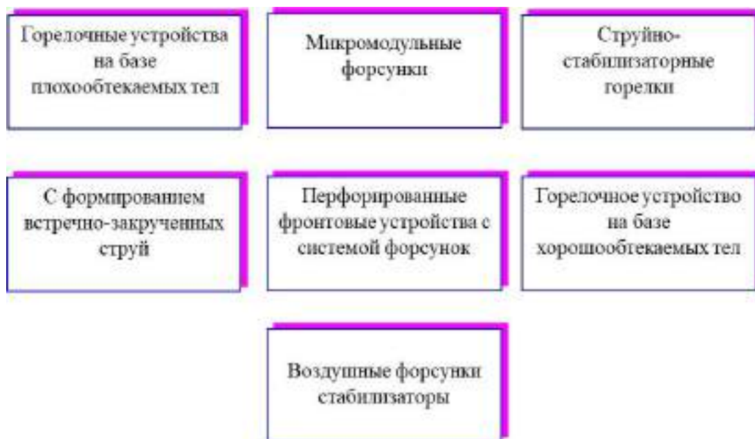
Рис.7.6. Основные типы микрофакельных горелочных устройств
