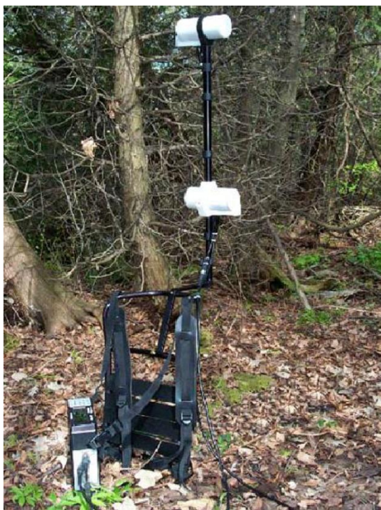
Рис. 5.3 Магнитометр GSM-19 в рабочем положении
