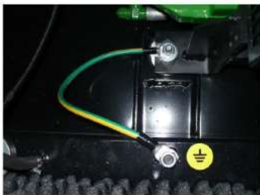
Рис. 4.1: Заземление внутренних компонентов
