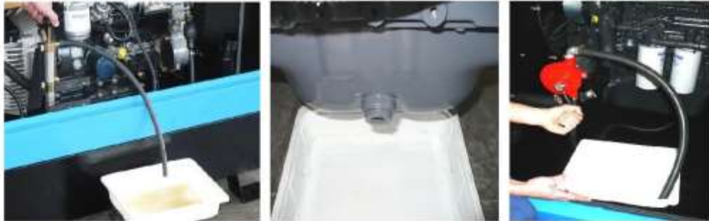
Рис. 6.2: Замена моторного масла
