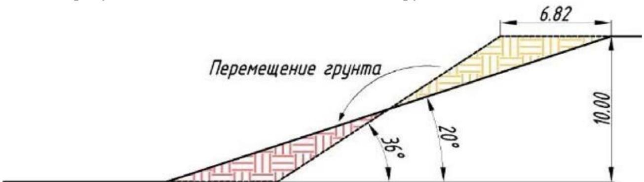
Рис. 5. Типовое поперечное сечение на схеме выполаживания отвала
