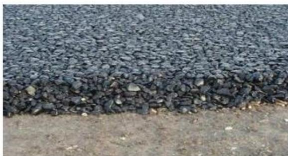
**Рисунок 10 – Общий вид щебеночно-мастичного асфальтобетона (ЩМА)**
