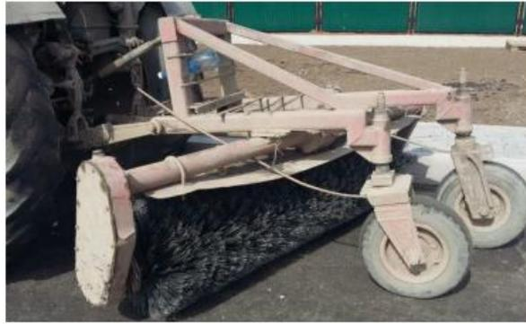
**Рисунок 3 - Механизм с щеткой на базе МТЗ-80**
