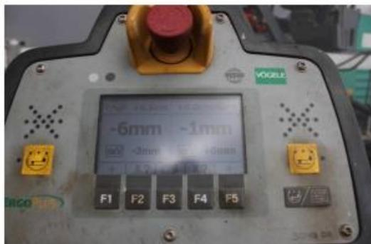
**Рисунок 9 – Автоматическая система асфальтоукладчика выдерживания толщины укладываемого асфальтобетона**
