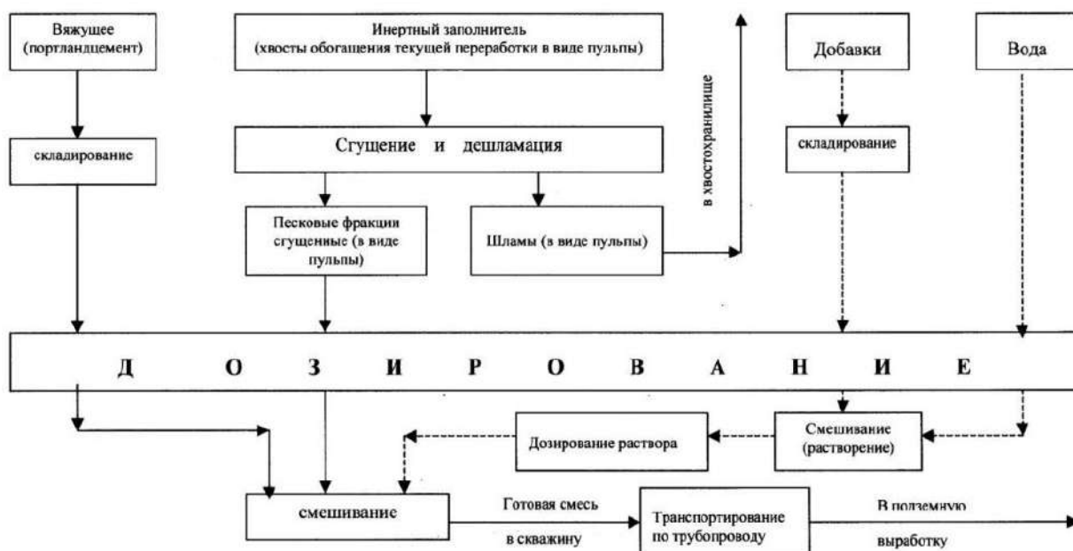
Рисунок 4.2.6. Схема технологического процесса приготовления твердеющей закладочной смеси на Риддер-Сокольном руднике
