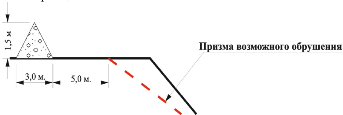
Рис.5.1- Схема ликвидации карьеров
