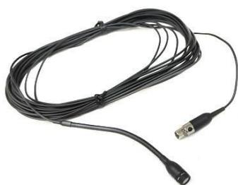
SHURE MX202B/C - это миниатюрный театрально-хоровой микрофон с кардиоидной направленностью. Микрофон на гибком креплении, длиной 10 см. и шнуром 9 м. Электретный конденсаторный миниатюрный микрофон популярной серии "MicroflexMX200" компании Shure предназначен для озвучивания хоров и выступлений артистов на сцене. Как правило этот тип микрофона размещают над головами исполнителей. Микрофон имеет высокую чувствительность и весьма широкий частотный диапазон 50 Гц —
