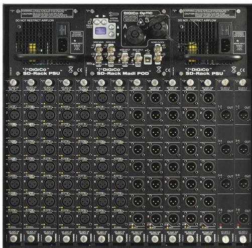
Интерфейсный модуль SD-Rack: 192 кГц, 10U рэковой высоты, 2 блока питания, 14 слотов для установки входных и выходных карт, 2 порта MADI, 2 разъема OpticalCON. В комплекте 2 x 5 м BNC кабель, 2 x 100 м BNC кабель, рэковые крепления. Без интерфейсных карт.
