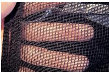
Голографический экран (тюль Gobelin) для прямой проекции размером 12.5 x 6.5 м., Состав 100% хлопок, Огнеупорность пожаробезопасный, евро класс EN 13501-1, Ячейка трапециевидная 4,3 x 1,7 мм ± (не деформируется даже при умеренном натяжении), цвет черный. Сверху армирование для подвеса с люверсами каждые 25 см.
