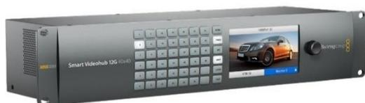
**Smart Videohub 12G 40x40** - коммутатор-маршрутизатор видеосигналов с интерфейсом 12G-SDI для одновременной маршрутизации SD-, HD- и Ultra HD-материала; 40 входов и выходов, синхровход, разъемы для подключения дополнительного источника питания и переднюю панель с большим Full HD-дисплеем для мониторинга и просмотра направлений маршрутизации; поддерживает работу со всеми SDI-стандартами.
