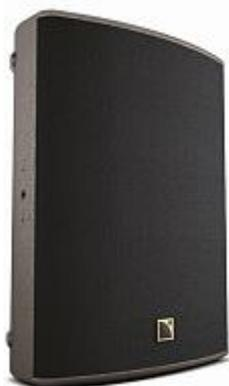
Акустическая система (fullrange) с номинальным сопротивлением 8 Ом в корпусе с фазоинвертором, где компрессионный драйвер с диафрагмой в 3", расположен коаксиально относительно НЧ/СЧ 12-дюймового динамика. Диапазон рабочих частот составляет от 59 Гц до 20 кГц. X12 имеет встроенный оригинальный пассивный кроссовер.
