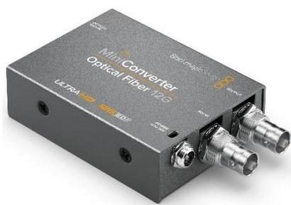
Mini Converter - Optical Fiber 12G - это конвертер для двустороннего преобразования SDI-сигнала в оптический поток и обратно. Многоскоростной интерфейс 12G-SDI обеспечивает работу со всеми SD-, HD- и Ultra HD-форматами вплоть до 2160p/60, в том числе при подключении к оборудованию обоих уровней (Level A и Level B). Установка оптического SFP-модуля с поддержкой 3G-, 6G- или 12G-SDI дает возможность использовать недорогие оптоволоконные кабели, с помощью которых создают компьютерные сети.
