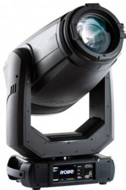
T1 обладает системой управления цветами CMY, фильтрами DataSwatch™ с предустановленными цветами, алгоритмом RCC™ (Robe Colour Calibration) нового поколения, радикально новой системой их создания и широким диапазоном управления CCT от 2700K до 8000K, поэтому вы можете получить любой оттенок. Система диммирования с разрешением 18 бит прекрасно подойдет для театра, а высокий индекс CRI поможет правильно передать тон кожи, что так необходимо в театре, на телевидении и в кино.
