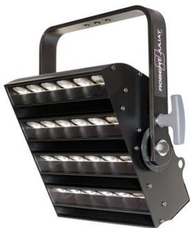
24 асимметричных микро-оптических отражателя расположены в 4 ряда в формате прямоугольного прибора. Для смешения цвета предлагается 8 цветов (красный, зелёный, синий, королевский синий, янтарный (амбер), циан, тёплый и холодный белый). Светильник создаёт равномерное асимметричное освещение с широким углом и идеально подходит для замены классических приборов с линейной лампой.
