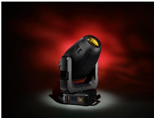
Профессиональный светодиодный полноповоротный прожектор рисующего света типа PROFILE. Источник света: Ultra-Bright Cold White LED 290W. Срок службы светодиодов 50000 часов. Световой выход 15400 лм. Температура белого света 7000 К. Угол раскрытия луча 3,8-55°. Эффекты: колеса статичных и вращающихся гобо, колесо анимации, кашетирующие шторки, призма. Поддержка протокола RDM.
