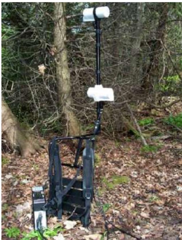
Рис. 5.3 Магнитометр GSM-19 в рабочем положении
