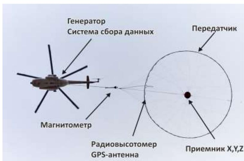
Рис. 5.8 Компоновка системы HorizOND
