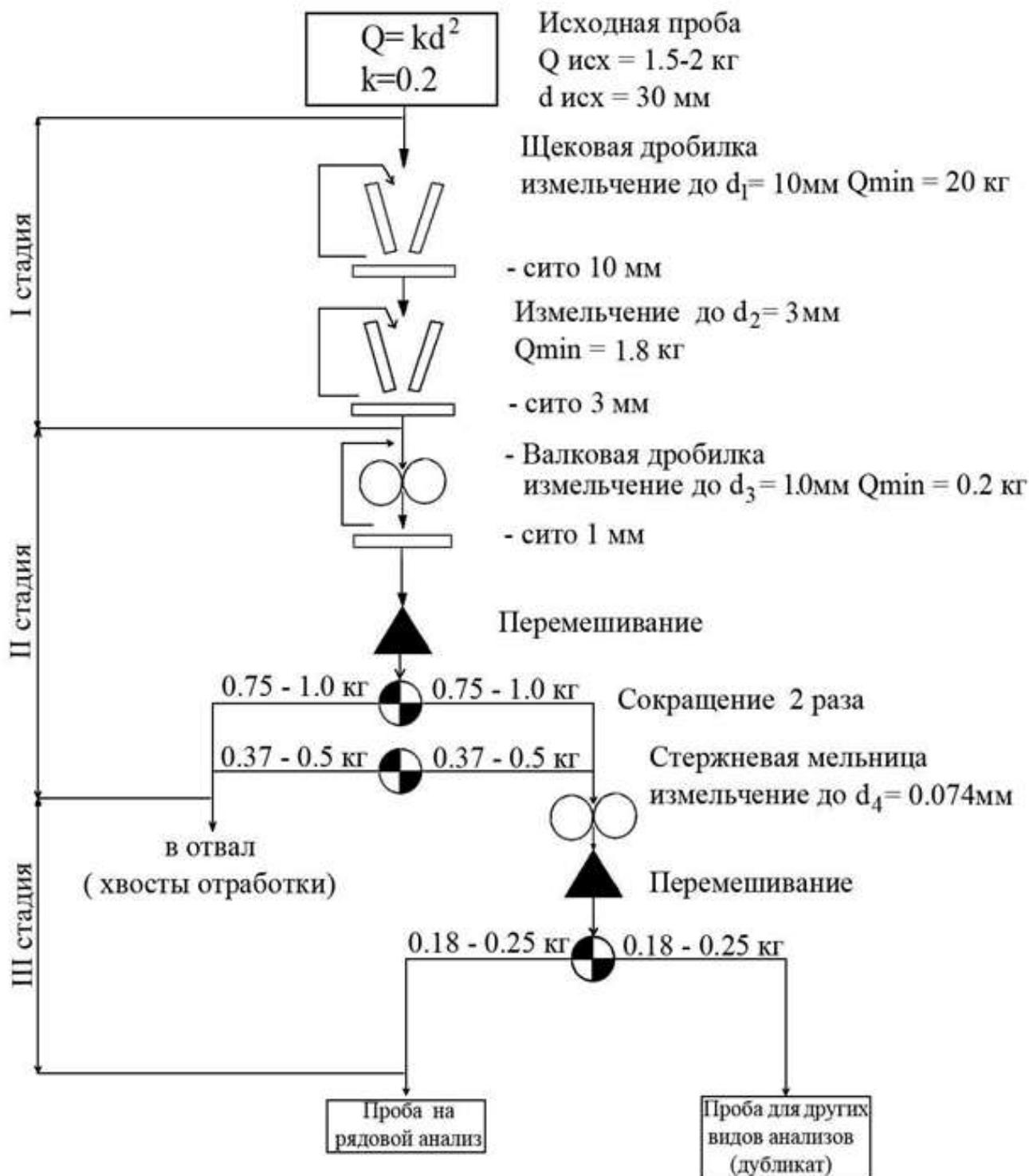
Рис. 5.14 Схема обработки геохимических проб
