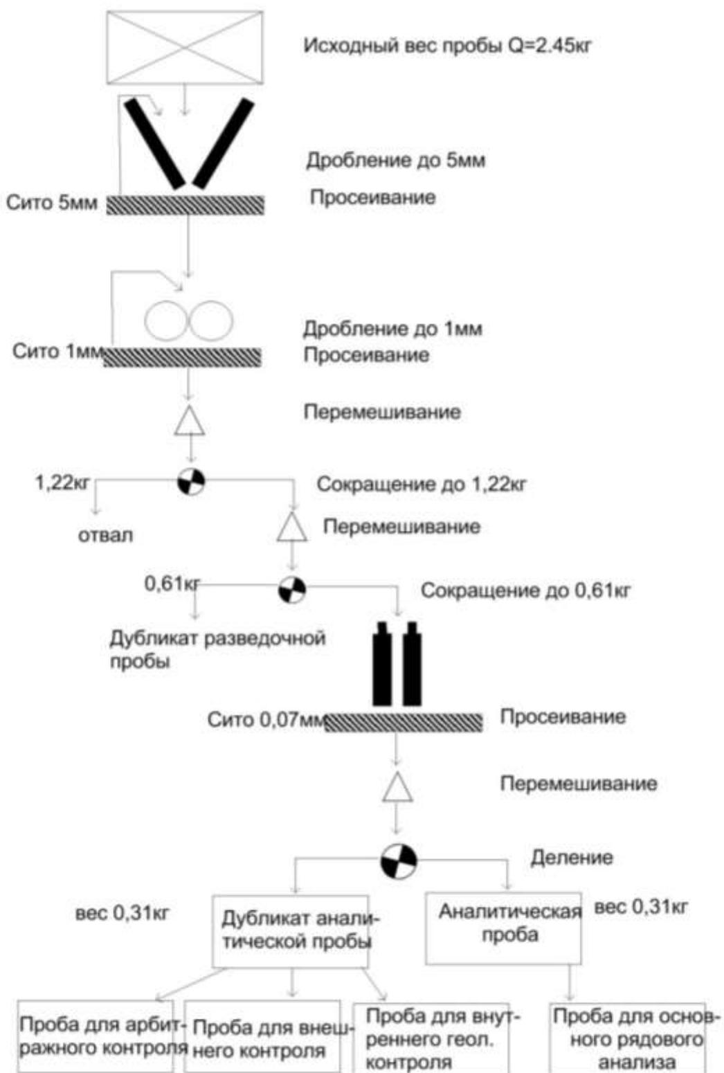
Рис. 5.15 Схема обработки керновых проб
