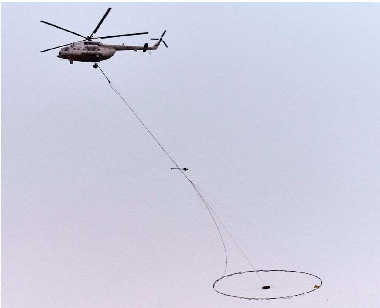
Рис. 5.7 Выполнение аэро-электроразведки
