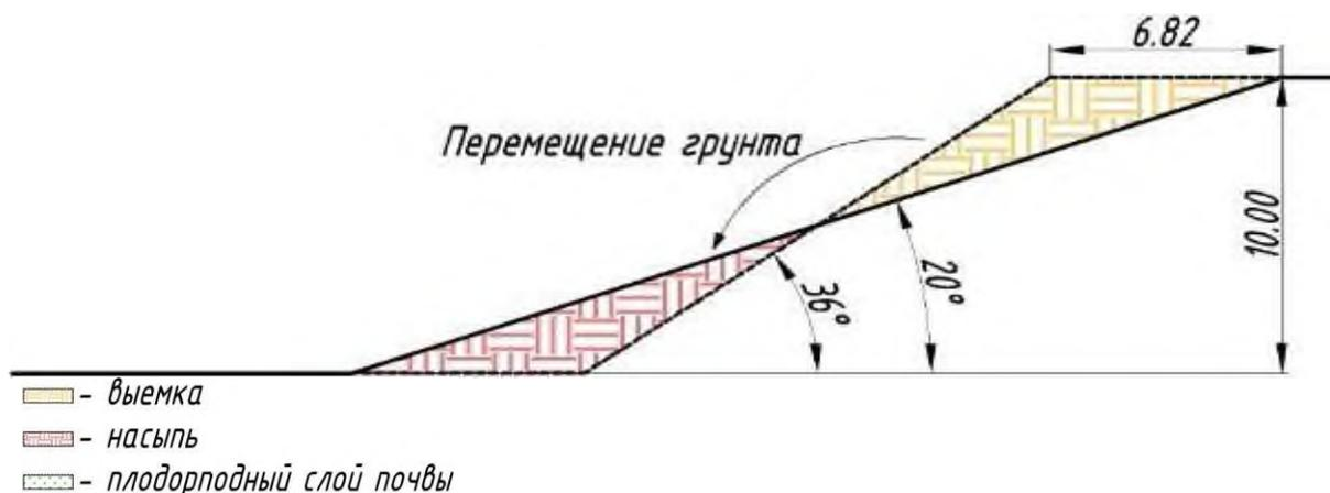
Рис.7 - Схема выполаживания отвала
