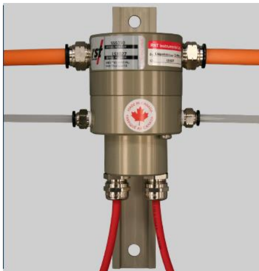
Рис.3 Внешний вид датчика гидравлической системы измерений осадки фундамента
