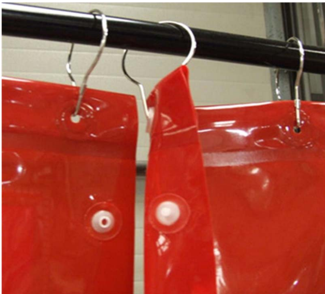
Рисунок 8 - Защитные сварочные ограждения рабочих зон
