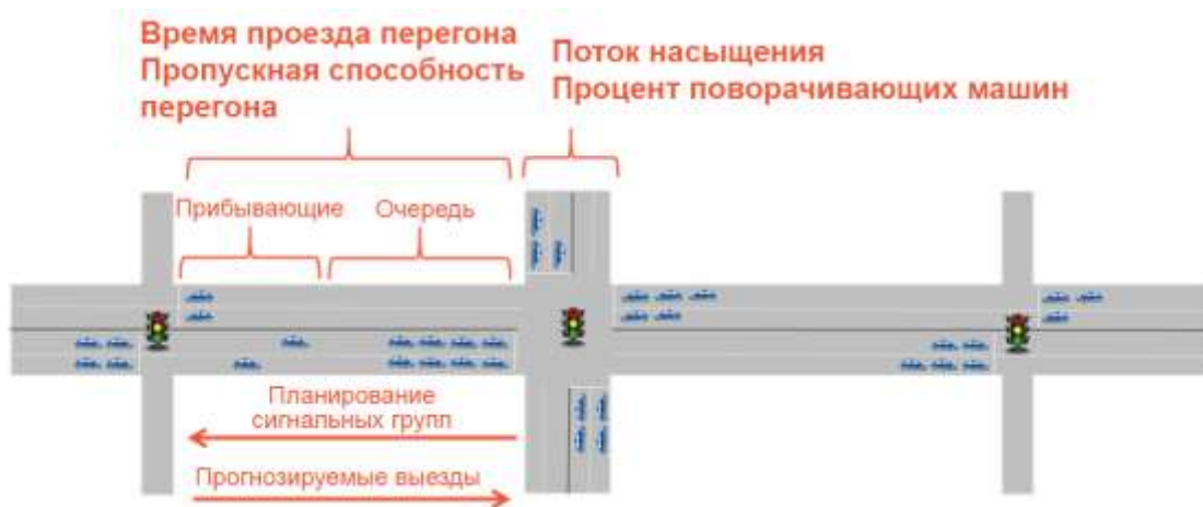
Рис. 4.1. Ключевые элементы прогноза состояния трафика в системе ImFlow
