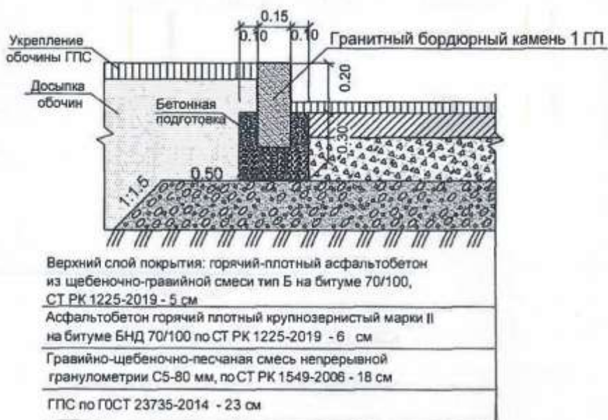
Рис. 3.2 Конструкция дорожной одежды тип 2
