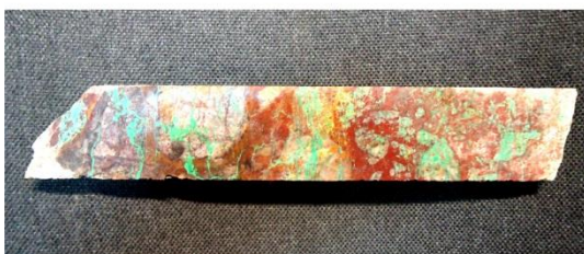
Участок Джарык-IV, скв. № 2, глубина 19,5 м. Малахит в зоне окисления
