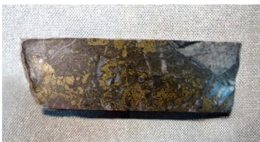
Участок Джарык-IV, скв. № 1, глубина 96 м. Гнезда халькопирита в эксплозивной брекчии
