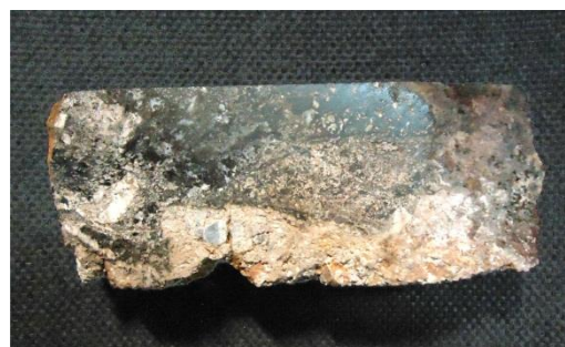
Участок Джарык-IV, скв. № 2, глубина 22,7 м. Агрегативные халькозиновые руды
